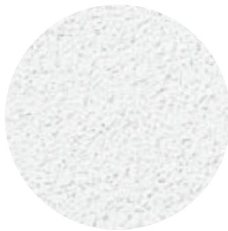
Wände: Abriebputz 1mm, gestrichen weiss
